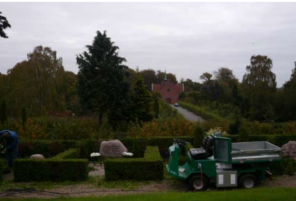
Kirkegårdsgartneren i Horsens bruger brinttruckens inverter til at drive hækkeklipperen. Truckens brændselscelleanlæg sørger for at holde batteriet opladet, så der kan arbejdes hele dagen, selv om der ikke er el indlagt på kirkegården. Foto: TI
