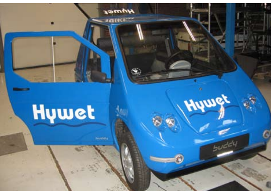
Den dansk-norske elbil Kewet er i efteråret 2007 ombygget til brint på AAU under navnet Hywet. Foto: IET-AAU
